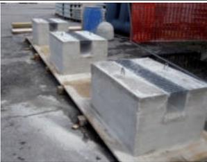
Campioni di canali tipo "M" per prova di carico
