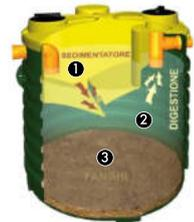
**CARATTERISTICHE TECNICHE:** le vasche biologiche tipo Imhoff sono costituite da due scomparti sovrapposti e idraulicamente comunicanti. Nel comparto superiore i solidi sedimentabili raggiungono per gravità il fondo del sedimentatore che ha una opportuna inclinazione per consentire il passaggio dei fanghi nel comparto inferiore dove avviene la digestione.
