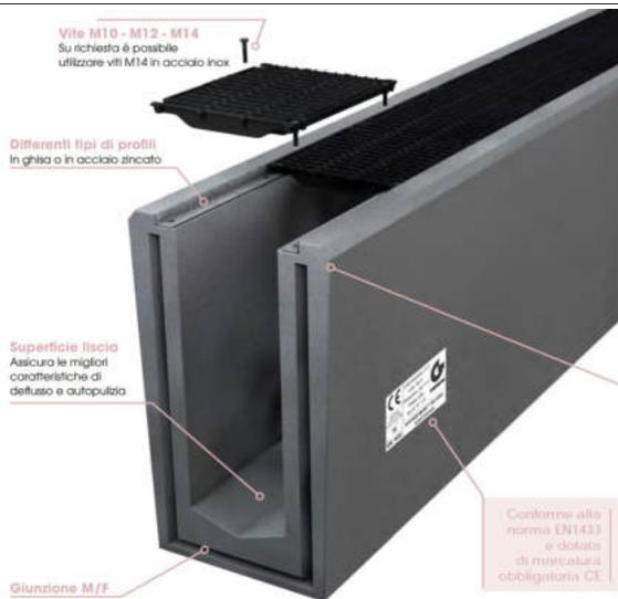
La gamma di canali di drenaggio STRONG è realizzata in calcestruzzo gettato armato ad elevata resistenza alla compressione, (classe minima C35/45 -  $f_{ck} = 35 \text{ N/mm}^2$  ed  $R_{ck} = 45 \text{ N/mm}^2$ ), ai cicli di gelo/disgelo in presenza di acqua stagnante contenente sali antighiaccio (classificazione +R secondo la norma EN1433) ed all'aggressione dovuta agli agenti atmosferici (classificazione W secondo la norma EN1433).
