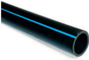
Tubi in polietilene PE100 (MRS 10) di colore nero con strisce identificative blu per la distribuzione dell'acqua per uso umano, incluso il trasporto dell'acqua prima del trattamento, con caratteristiche conformi alle norme UNI EN 12201 ed ISO 4427, proprietà organolettiche verificate secondo UNI EN 1622 e proprietà igienico-sanitarie conformi alle prescrizioni normative del D.M. n. 174 del 6/4/2004 per il trasporto di acqua potabile.
