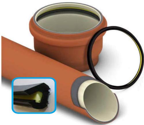
Tubi con parete strutturata a triplo strato in polipropilene alto modulo (PPHM); strato interno ad alta resistenza all'abrasione, strato intermedio ad alta rigidità meccanica; strato esterno protettivo ad alta resistenza agli agenti atmosferici ed ai danni superficiali.
