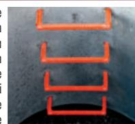
Gli elementi delle camerette circolari possono essere forniti con scalini antiscivolo alla marinara a norma UNI EN 13101 premontati in stabilimento e fabbricati mediante incapsulazione ad alta pressione di un copolimero di polietilene, resiste all'attacco di soluzioni di solforico e idrogeno solforato al 50%.
