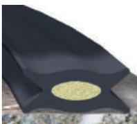
Basic è un tubo di gomma riempito con sabbia di quarzo fine, che pareggia le irregolarità degli anelli del pozzetto in calcestruzzo e trasmette le sollecitazioni statiche e del traffico sulla zona apposta.
