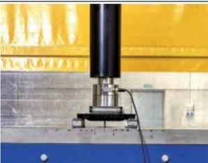
Prova capacità portante e deformazione sotto carico su griglia di acciaio
