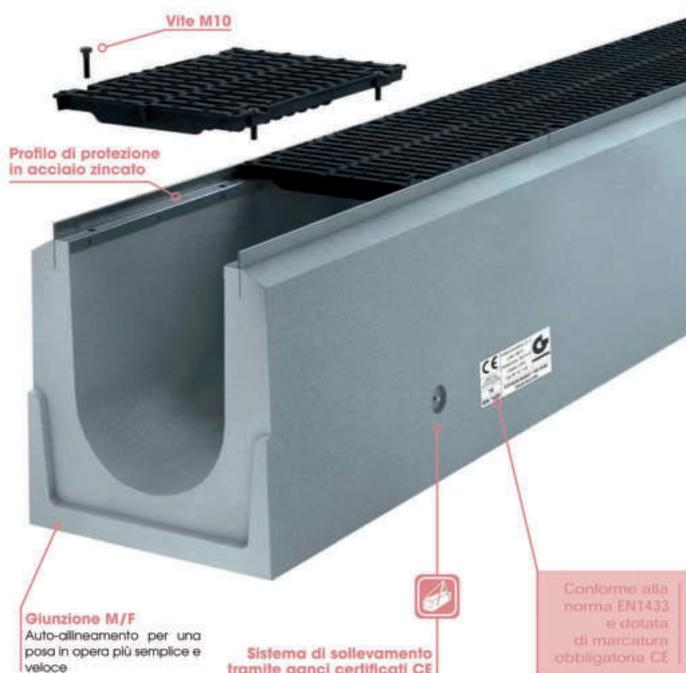
La gamma dei canali autoportanti BIG I nS D400 è realizzata in calcestruzzo gettato armato ad alta resistenza a compressione (classe C40/50 -  $f_{ck} = 40 \text{ N/mm}^2$  ed  $R_{ck} = 50 \text{ N/mm}^2$ ), ai cicli di gelo/disgelo in presenza di acqua stagnante contenente sali antighiaccio (classificazione +R secondo la norma EN1433) ed all'aggressione dovuta agli agenti atmosferici (classificazione W secondo la norma EN1433).
