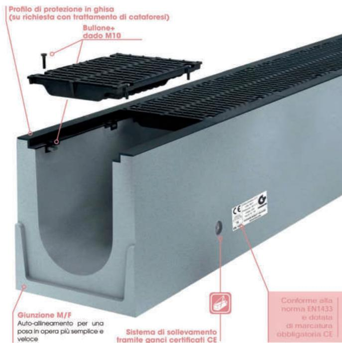
La gamma dei canali autoportanti BIG I nS D400 è realizzata in calcestruzzo gettato armato ad alta resistenza a compressione (classe minima C40/50 -  $f_{ck} = 40 \text{ N/mm}^2$  ed  $R_{ck} = 50 \text{ N/mm}^2$ ), ai cicli di gelo/disgelo in presenza di acqua stagnante contenente sali antighiaccio (classificazione +R secondo la norma EN1433) ed all'aggressione dovuta agli agenti atmosferici (classificazione W secondo la norma EN1433).
