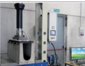
Prova di carico su canali tipo "I"
