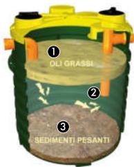
**CARATTERISTICHE TECNICHE:** La degrassatura è un pretrattamento fisico di rimozione degli oli, delle schiume, dei grassi e di tutte le sostanze che hanno peso specifico inferiore a quello del liquame.
