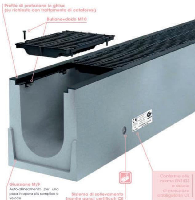
La gamma dei canali autoportanti BIG I nS F900 è realizzata in calcestruzzo gettato armato ad alta resistenza a compressione (classe minima C55/67 -  $F_{ck} = 55N/mm^2$  e  $R_{ck} = 67 N/mm^2$ ), ai cicli di gelo/disgelo in presenza di acqua stagnante contenente sali antighiaccio (classificazione +R secondo la norma EN1433) ed all'aggressione dovuta agli agenti atmosferici (classificazione W secondo la norma EN1433).
