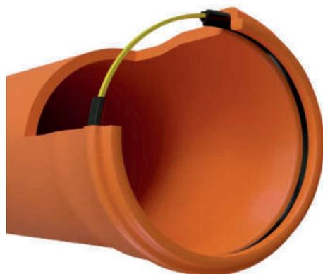
Tubi ad alta resistenza con parete mono strato in POLIPROPILENE ALTO MODULO (PPHM) per condotte di scarico interrate non in pressione. Disponibile nelle serie SN 8 KN/m<sup>2</sup> e SN 16 KN/m<sup>2</sup>. Idoneo per la posa a -10°C.
