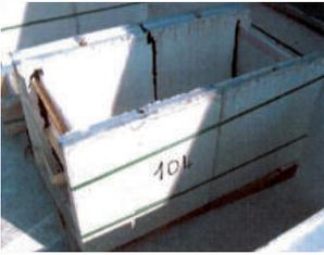
Campioni per prova di tenuta all'acqua delle giunzioni delle canalette di drenaggio
